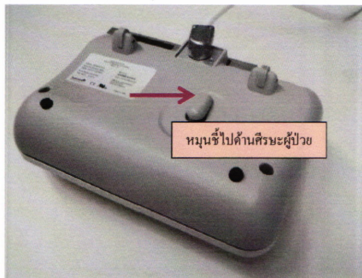
ภาพที่ 7 การปรับเปลี่ยนทิศทางการหมุนของ C-Arm เมื่อมีการย้าย Gemetry Module ไปยังตำแหน่งต่าง ๆ รอบ ๆ เตียง
